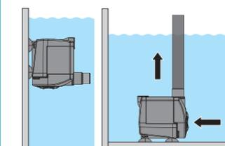
注意:設置する際、運転による振動や排出時の水の力によってポンプが水槽や岩石にぶつからないよう固定してください。
